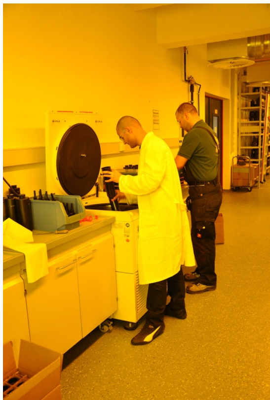
Bild: DYMAX Mitarbeiter bei der Zentrifugierung von Klebstoffkartuschen, um diese von Luftblasen zu befreien.
