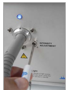
Regelung der Intensität mit Justierstift (bei abgenommenem Drehknopf)
