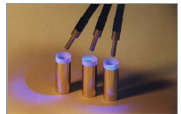
Dreifachlichtleiter zur Aushärtung bei Metall-Kunststoffverklebung
