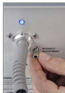
Regelung der Intensität mit Drehknopf (abnehmbar)
