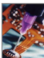
Verkapselung auf flexibler Leiterplatte
