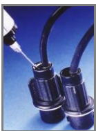
Verguss von Kabeln
