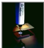
Verklebung von Kühlkörpern
