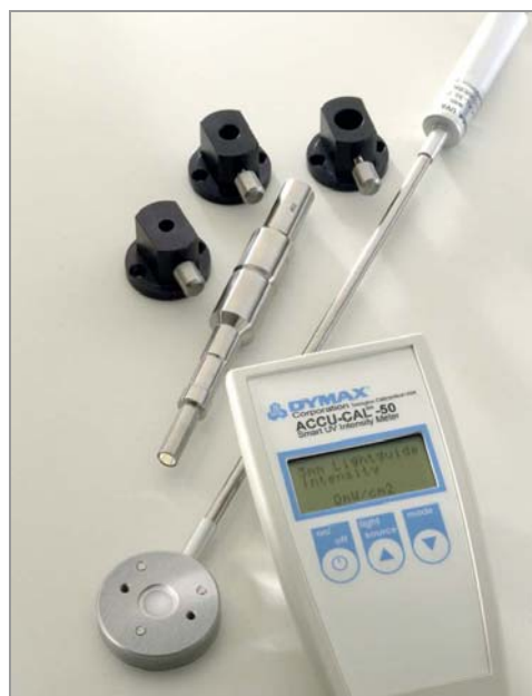
ACCU-CAL ™ 50 pour la mesure des lampes : Spot projection et convoyeurs
