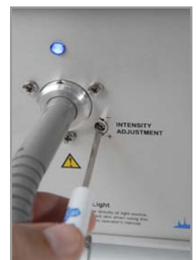
Le bouton enlevé, le réglage peut être effectué à l'aide d'un outil adéquatement approvisionné
