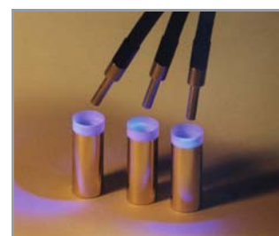
Guide lumière à trois brins pour réticulation lors d'un assemblage plastic / métal
