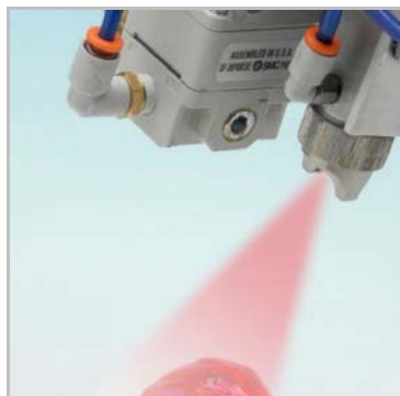
Pulvérisation de résine sur implant de rotule
