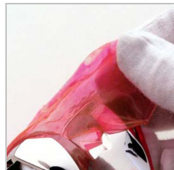
Elimination du masque par pelage
