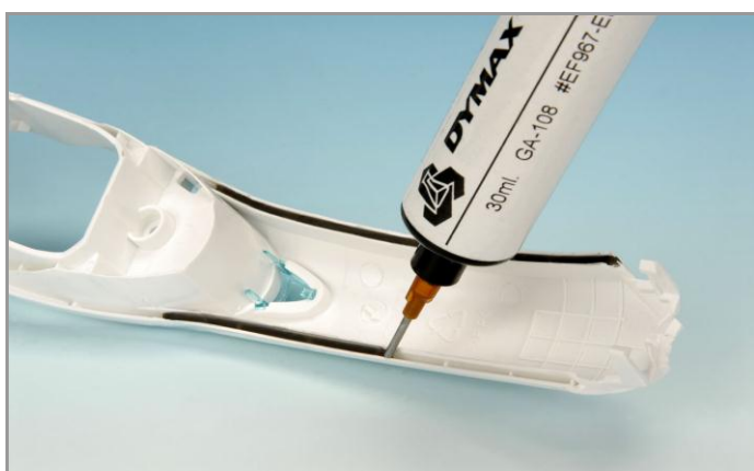
Auftragen der Dichtungs-Raupe auf den Griff eines Haushaltsgeräts
